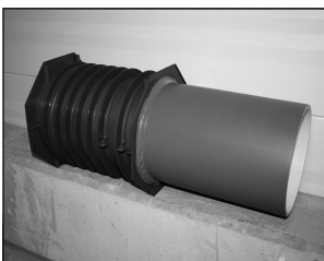
40 - 60 cm seinäpaksuuksille käytetään 600 mm ripaputkea.
