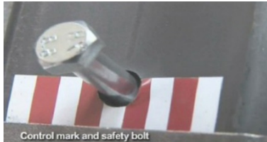
Punavalkoraidallinen teippaus ja kuusioruuvi varmistuksena
