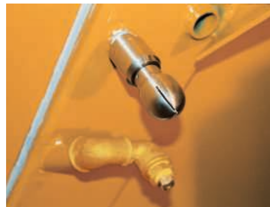
Pyörivä huuhtelusuutin (suuttimet) puhdistaa sekoittimen kansien alapinnan.
