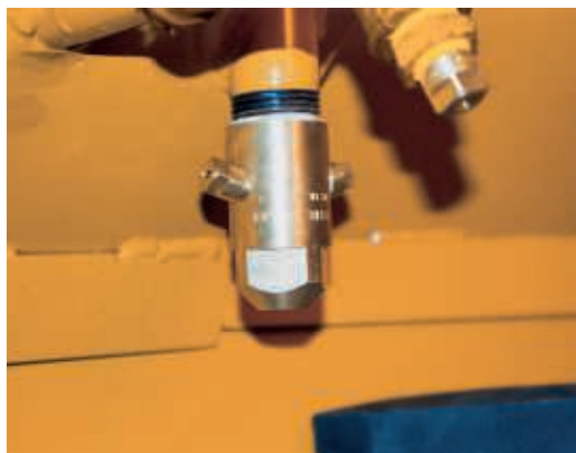
Pystysuora huuhtelusuutin sivukaapimen ja sekoitusvarsien alaosan puhdistamiseen.
